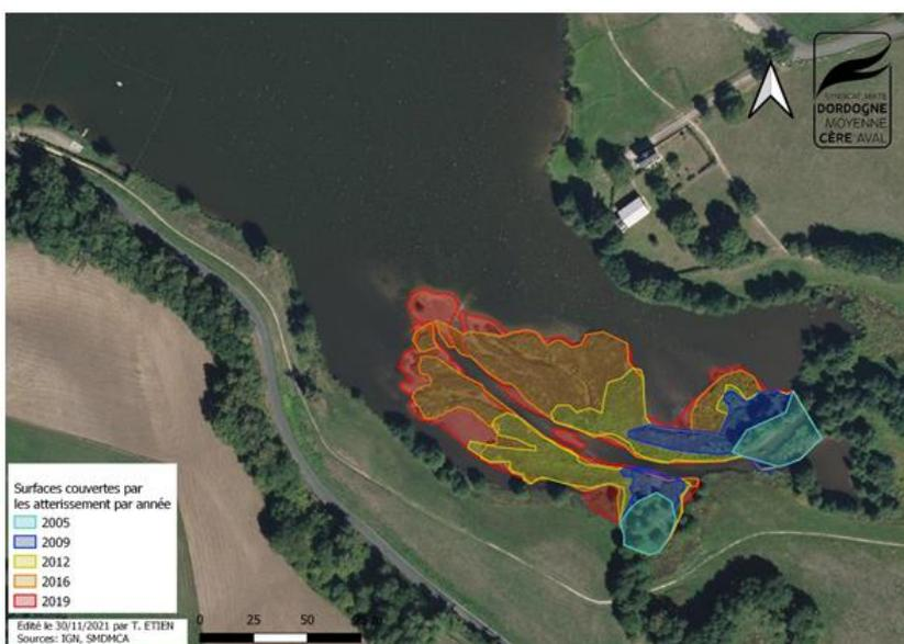
**Lutte contre l'ensablement du lac de Tolerme** : Problématique d'un apport excessif de sédiments (vases et sables) dans la queue d'étang, menaçant un captage d'eau potable et les usages touristiques.
